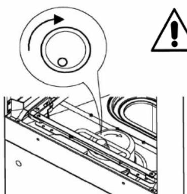
POZOR: V případě špatného směru otáčení je systém mechanického zabezpečení posunu neúčinný.
